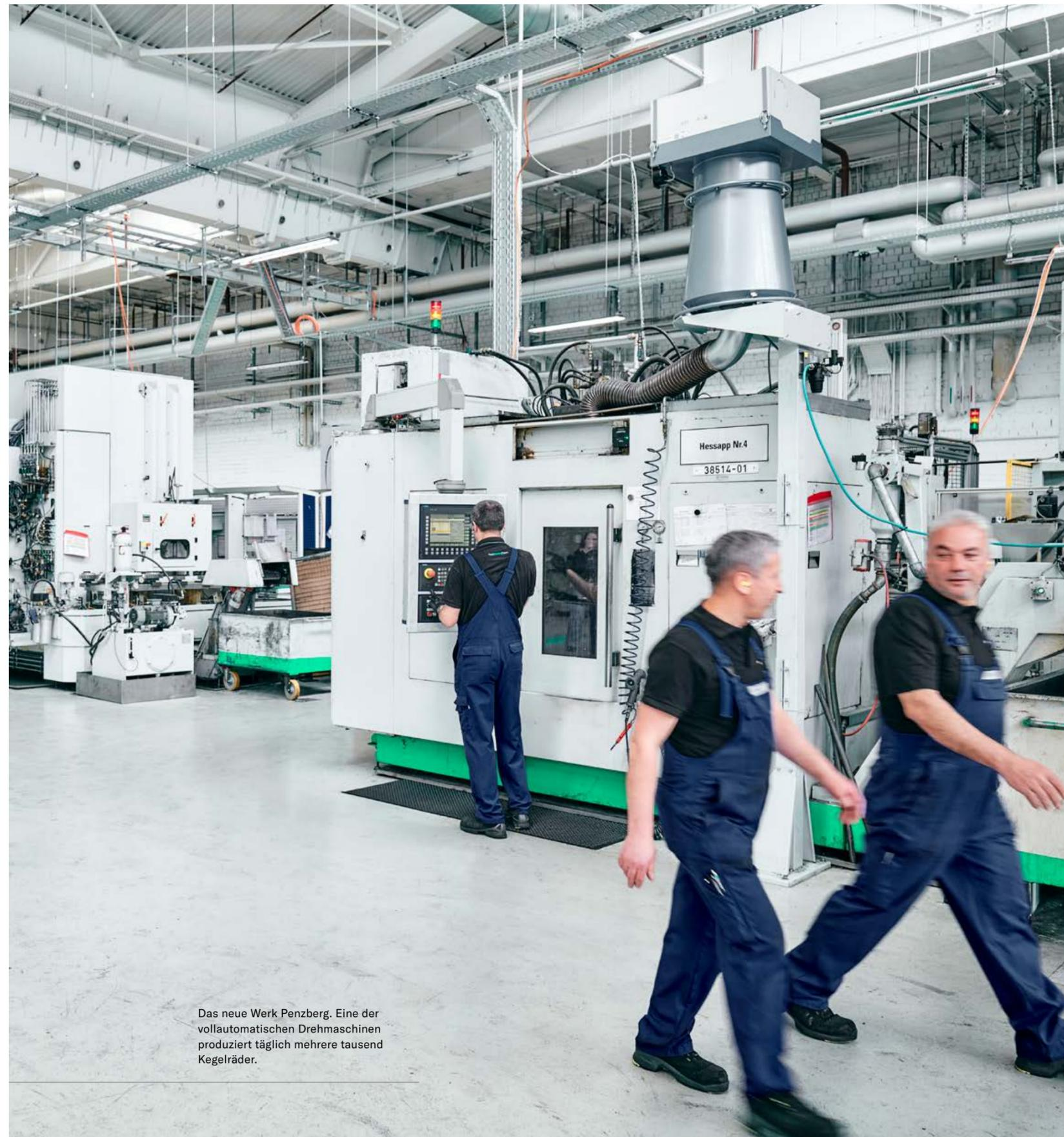
Das neue Werk Penzberg. Eine der vollautomatischen Drehmaschinen produziert täglich mehrere tausend Kegelräder.
